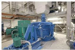
Vertikale Prallbrecher vom Typ Multirok kommen in der dritten und vierten Brechstufe zur Splitt- und Sandproduktion zum Einsatz und sind für mittelhartes und hartes Gestein geeignet. Dank ihrer Flexibilität sind die Anlagen des Herstellers Thyssenkrupp auch in stationären, semi-mobilen sowie mobilen Anlagen einsetzbar.
